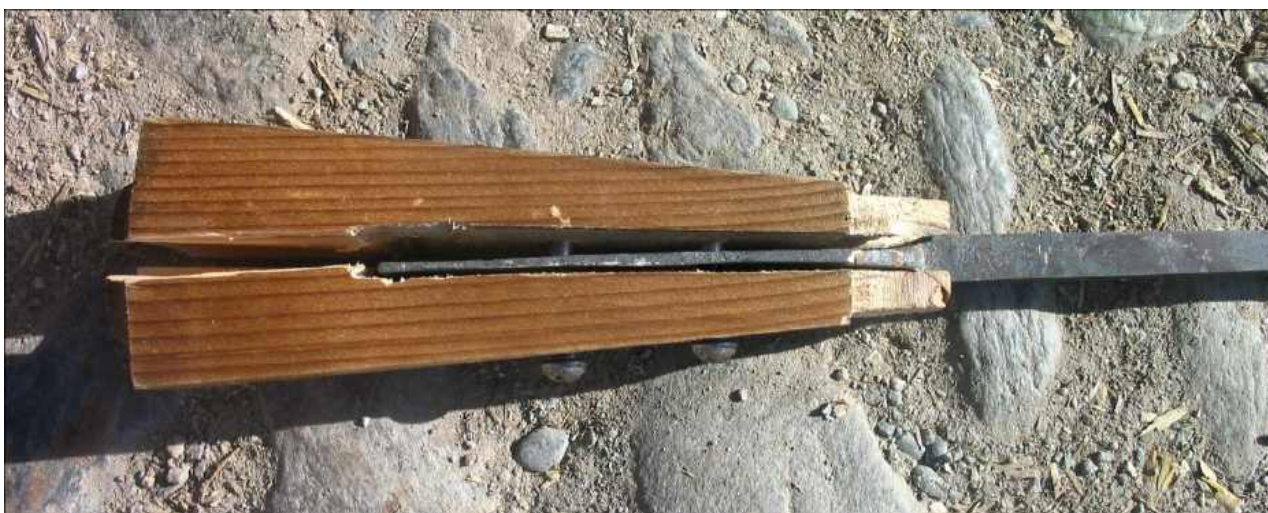
Fig.5: rottura della testa del pilum. Per meglio evidenziarla è stata smontata la testa e tolto il collare. Da notare la sezione del codolo "immersa" nella testa all'altezza del collare (parte chiara del legno).
